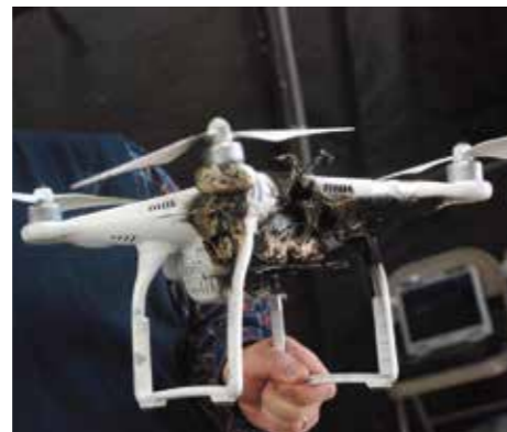
Dálkově řízená kvadroptéra použitá jako terč při testech systému HELMTT.
